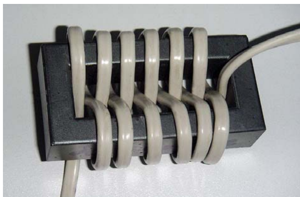
Bild 1: Rechteck-Kern bewickelt in Super-8-Technik
